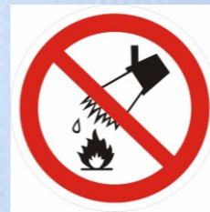
Запрещено тушить водой
